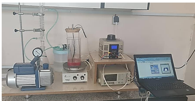
شکل ۱: شماتیک و تصویر سامانه گرمایش اهمی - خلاء
