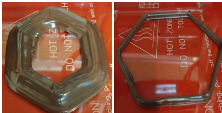
شکل (۹) چاپ شکلات با قطر نازل 1.5\text{ mm} در دمای 32^{\circ}\text{C} و سرعت 200\text{ mm/min} (الف) ارتفاع 3\text{ mm} (ب) ارتفاع 30\text{ mm} Fig 9. Chocolate printing with a nozzle diameter of 1.5\text{ mm} at 32^{\circ}\text{C} and a speed of 200\text{ mm/min} a) height 3\text{ mm} b) height 30\text{ mm}
