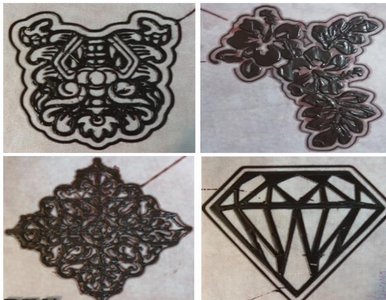
شکل (۷) چاپ اشکال پیچیده با قطر نازل 1/5\text{ mm} در دمای 32^{\circ}\text{C} و سرعت ثابت 1200\text{ mm/min} Fig 7. Complex shapes with a nozzle diameter of 1.5\text{ mm} at 32^{\circ}\text{C} and a constant speed of 1200\text{ mm/min}
