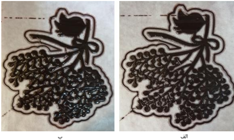
شکل (۶) چاپ طرح پیچیده با قطر نازل 1/5\text{ mm} و سرعت ثابت 1200\text{ mm/min} (الف) 32^{\circ}\text{C} و (ب) 40^{\circ}\text{C} Fig 6. with nozzle diameter of 1.5\text{ mm} and constant speed of 1200\text{ mm/min} a) 32^{\circ}\text{C} and b) 40^{\circ}\text{C}
