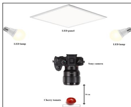
شکل (۱) شکل شماتیک سیستم تصویربرداری Fig1. Schematic diagram of image acquisition set-up
