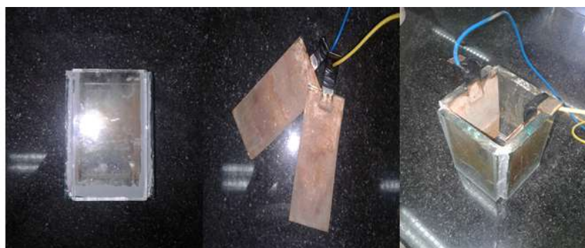
شکل (۱) شکل واقعی و نمودار شماتیک انجام پیش تیمار اهمیک
