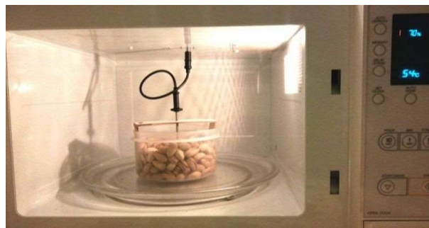
شکل (۱) دستگاه میکروویو به همراه ترمومتر ۱- ترمومتر، ۲- نمایشگر توان، ۳- نمایشگر دما
