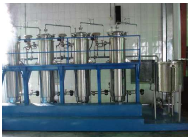
شکل (۴) واحد استخراج چند مرحله‌ای جهت استخراج مواد موثره از گیاه رزماری با حلال اتانول
