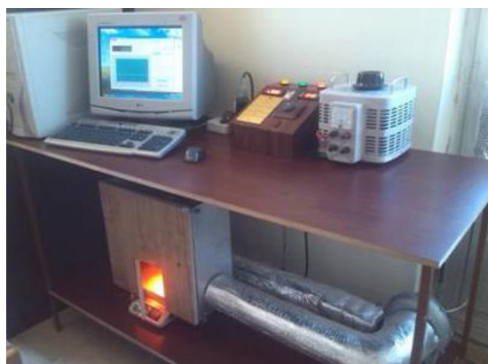
شکل (1) سامانه مادون قرمز-هوای داغ جهت خشک‌کردن قارچ دکمه‌ای
