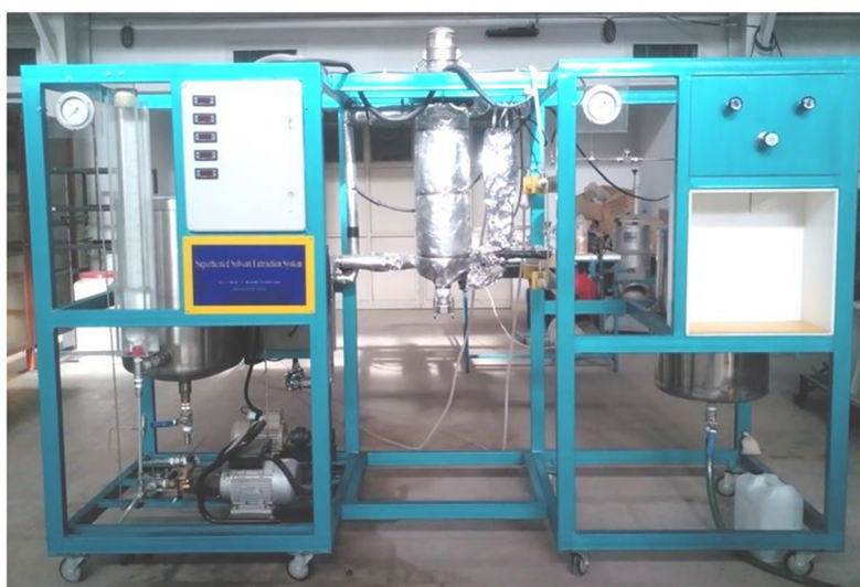
شکل (۲) شماتیک دستگاه استخراج با آب داغ تحت فشار در مقیاس پیلوت
