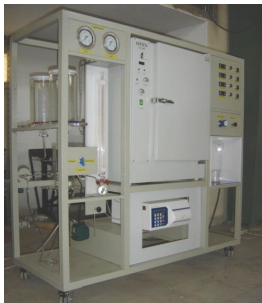
شکل (۲) دستگاه استخراج با آب در دمای زیر بحرانی.
