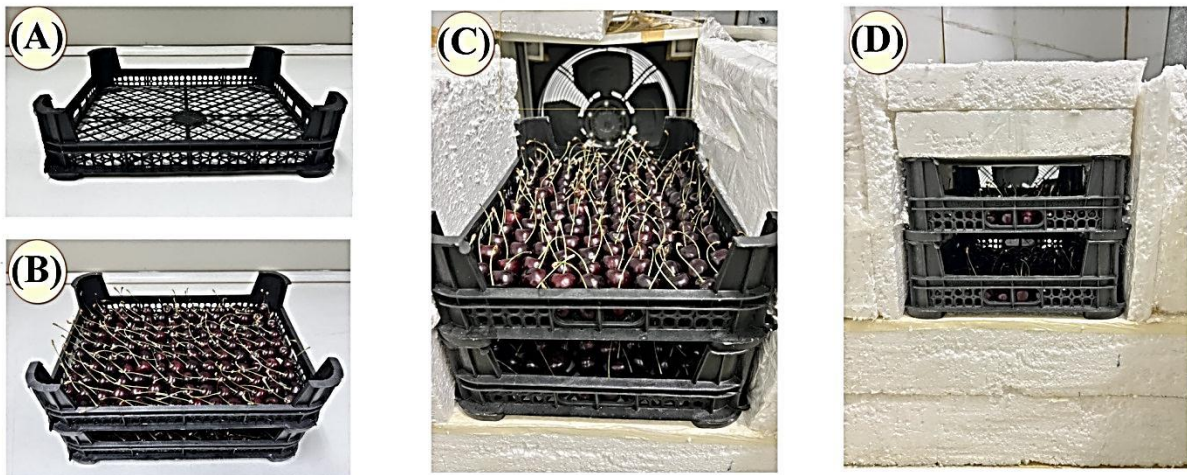
شکل (۳). پیش سرمایش گیلان به روش FAC؛ (A) جعبه‌های متداول برداشت، (B) چینش میوه‌ها در جعبه‌ها، (C) نحوه قرارگیری جعبه‌ها در داخل تونل باد، (D) آببندی اطراف جعبه‌ها
