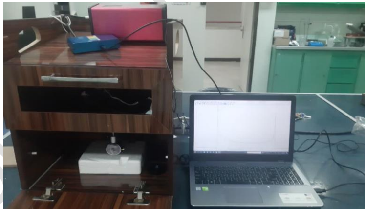
شکل ۲. نمایی از سیستم طیف‌سنجی VIS/NIR مورد استفاده برای جمع‌آوری داده‌ها
