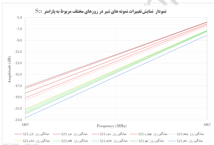
شکل (۶): تغییرات S_{21} در فرکانس ۱۸۰۷ MHz و ۱۸۶۷ MHz
