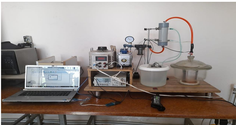
شکل (۱) شماتیک و تصویر سامانه گرمایش اهمی - خلاء مورد استفاده در فرایند تغلیظ آب انگور Fig 1. Schematic and picture of the ohmic-vacuum concentration system for grape juice
