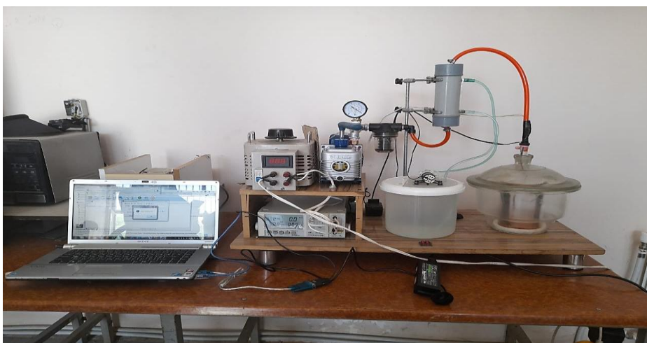
شکل (۱). شماتیک و تصویر سامانه گرمایش اهمی - خلاء مورد استفاده در فرایند تغلیظ آب انگور
