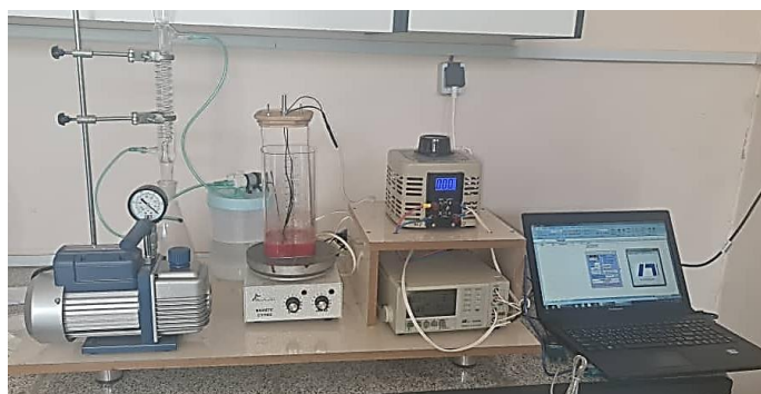
شکل ۱: شماتیک و تصویر سامانه گرمایش اهمی - خلاء
