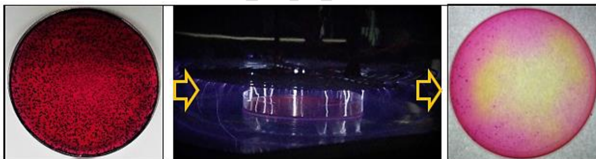
شکل ۲ غیر فعال سازی رشد سالمونلا انتریکا سروتیپ انتریتیدیس به روش تخلیه پلاسمای سرد اتمسفری سد دی الکتریک
