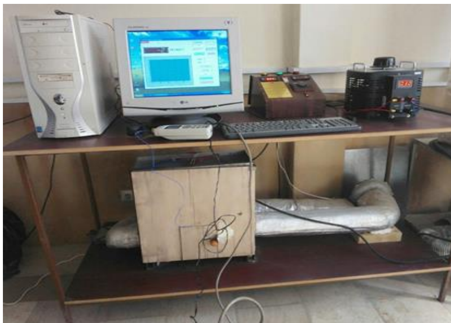
شکل (۲). تصویر دستگاه مورد استفاده برای انجمادزایی ترکیبی تابش مادون قرمز - هوای گرم
