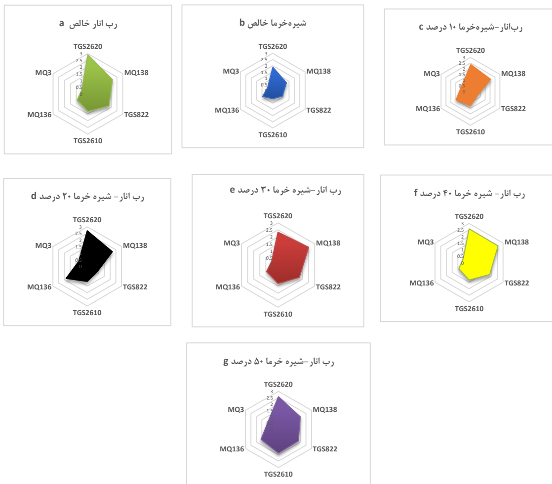
شکل (۳) نمودار رادار پاسخ حسگرها برای سطوح مختلف تقلب ربانار: (a) ربانار خالص، (b) شیره خرما خالص، (c) ربانار-شیره خرما ۱۰٪، (d) ربانار-شیره خرما ۲۰٪، (e) ربانار-شیره خرما ۳۰٪، (f) ربانار-شیره خرما ۴۰٪، (g) ربانار-شیره خرما ۵۰٪
