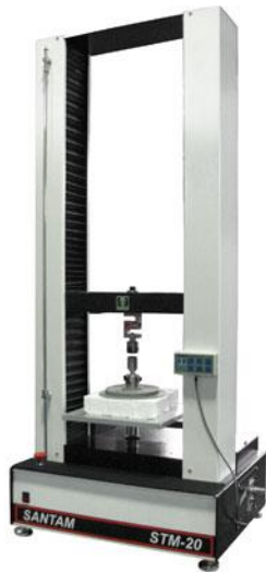
شکل (۲) دستگاه تست بافت (یونیورسال سری ۲۰-STM) Fig 2. Texture testing machine (Universal 20-STM series)
