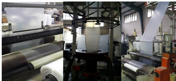
شکل (۱) دستگاه اکسترودر دمشی مورد استفاده در تولید نانوکامپوزیت‌های پلیمری
