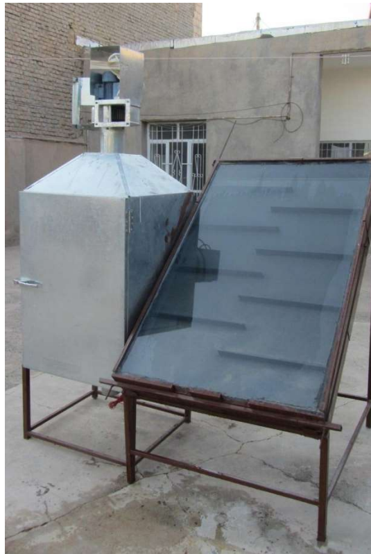
شکل (۱) ساختار شماتیک خشک‌کن خورشیدی طراحی شده برای خشک‌کردن نعناع لعلی، (۱) حسگر کنترل‌کننده دما و رطوبت نسبی هوای ورودی به کلکتور، (۲) تیغه، (۳) صفحه جاذب، (۴) کلکتور خورشیدی چندگذر، (۵) اتصالات و لوله‌های رابط، (۶) پایه (شاسی) نگه‌دارنده کلکتور و محفظه خشک‌کن، (۷) حسگر کنترل‌کننده دما و رطوبت نسبی هوای ورودی به خشک‌کن، (۸) دیتالاگر، (۹) کامپیوتر، (۱۰) محفظه خشک‌کن، (۱۱) سیم‌های رابط، (۱۲) حسگر کنترل‌کننده دما و رطوبت نسبی هوای خروجی از خشک‌کن و (۱۳) فن سانتریفوژ
