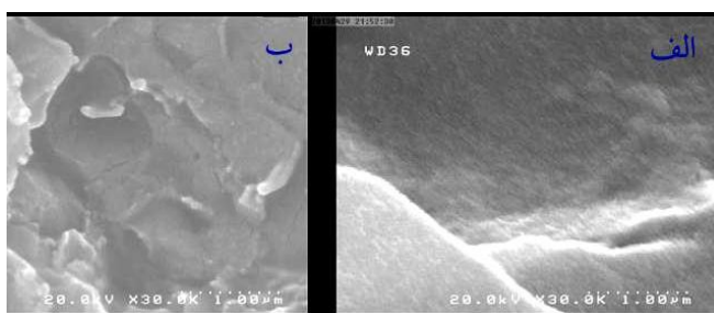
شکل (1) تصویر FE-SEM الف: فیلم فاقد مونت موریلونیت و ب: فیلم حاوی 5٪ مونت موریلونیت
