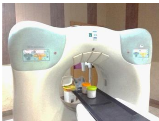
شکل (1) نحوه قرارگیری نمونه خمیر در دستگاه سی‌تی‌اسکن
