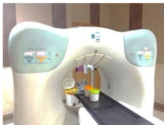
شکل (۱) نحوه قرارگیری نمونه خمیر در دستگاه سی‌تی‌اسکن
