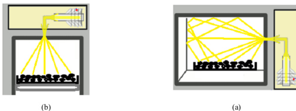
شکل (3) نحوه امواج دهی به محصول در خشک‌کن میکروویو خانگی (a) و خشک‌کن میکروویو جریان مداوم (b)
