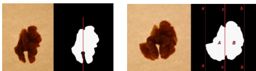
شکل (4) نحوه تشخیص گروه نیمه از ربعی براساس تعیین محور تقارن شیء
