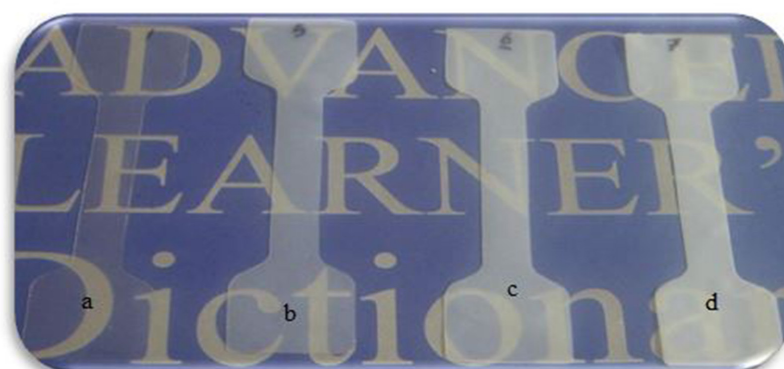
شکل (۶) ظاهر فیلم‌های نانو کامپوزیتی نشاسته‌ای: (a) PS، (b) PS-0.5% \text{TiO}_2 ، (c) PS-1% \text{TiO}_2 و (d) PS-2% \text{TiO}_2
